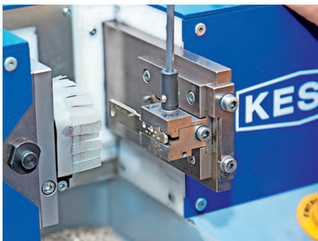
Ein Programm steuert die Fräsnadel und sagt ihr, wo sie wie tief in den Schlüsselrohling fräsen muss – auf den Hundertstelmillimeter genau.
