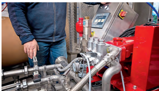
La désalcoolisation se fait par les processus d'osmose et de distillation. Le responsable technique Grégoire Dupertuis est déjà coutumier des toutes nouvelles installations.
